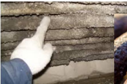
Incrustación severa en tubería de condensador evaporativo
