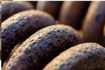
Corrosión por un desbalance en el pH del agua
