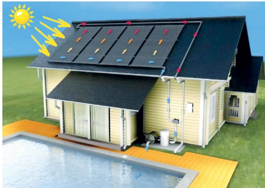
**Figura 1. Incidencia de la energía solar sobre un tren de cuatro paneles**
