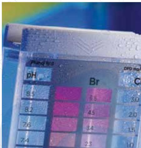
El **THREE CHAMBER TESTER** es un colorímetro de tres cámaras o celdas que contiene indicadores: DPD #3 suficientes para 10 pruebas de Cloro Total, DPD #1 para 20 pruebas de Cloro Libre o Bromo y Rojo Fenol para 10 pruebas de pH.
