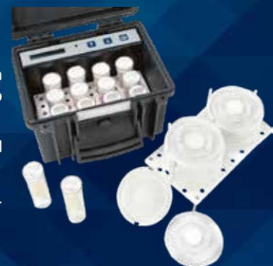
En su uso con cultivos laminares, **la incubadora DI 10 de Lovibond®** permite un control microbiológico eficiente del refrigerante de conformidad con las distintas directivas europeas.
