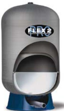
Los tanques de fibra de vidrio **FLEX 2 PRO**, incorporan el mismo sistema de doble membrana CAD-2 y son montados sobre las mismas bases de ABS de alta resistencia, con conexiones de PVC cédula 80. Los cuerpos de los tanques son de fibra de vidrio bobinada con pintura gris que incluye un protector contra rayos UV. Esta es la mejor opción para climas extremos en donde se requiere un tanque anti-corrosible.
